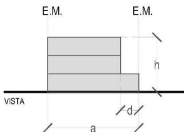
Esquemas en corte, planta y vista del manejo posible de los volúmenes edificados para el distrito R1, para lotes de frentes de 12 metros hasta 20 metros de frente y de 250 m<sup>2</sup> hasta 600 m<sup>2</sup> de superficie.
