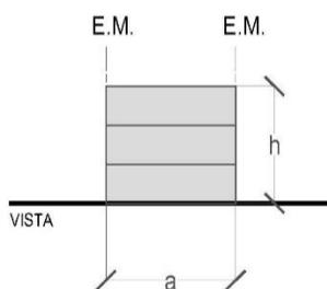
*Esquemas en corte, planta y vista del manejo posible de los volúmenes edificados para el distrito R1, para un lote de 10 metros hasta 12 metros de frente y de 250 m2 hasta 600 m2 de superficie.*
